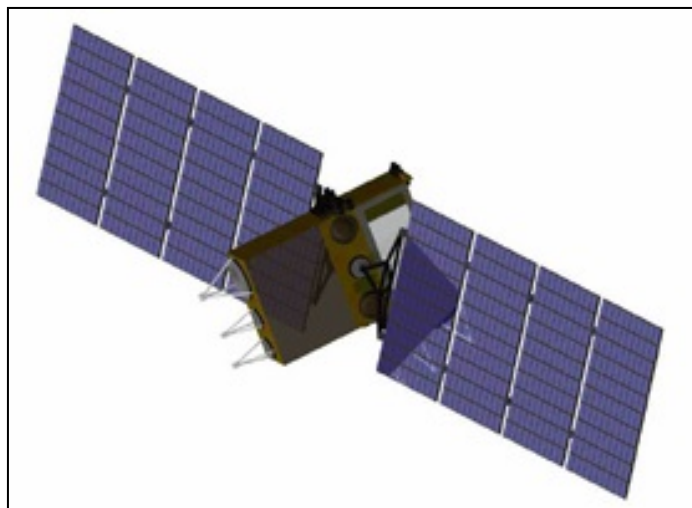
Рис. 1.12. Предполагавшаяся конструктивная схема ИСЗ LYBID
