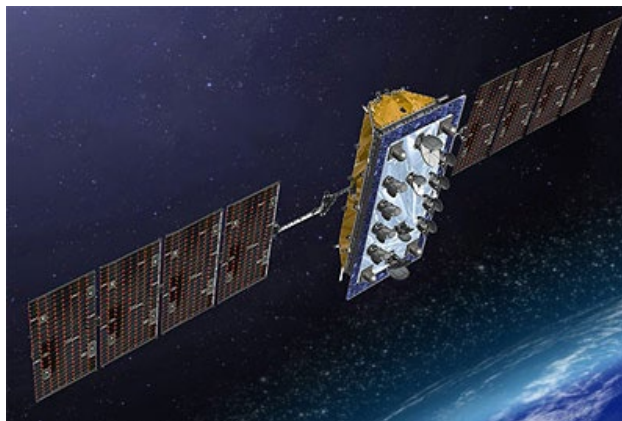
Рис. 2.8. Возможное конструктивное исполнение ИСЗ системы LeoSat
